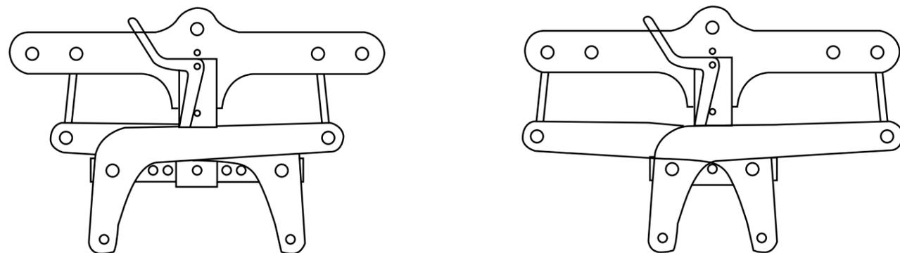
I disegni mostrano le diverse regolazioni delle ganasce della pinza, e la relativa predisposizione delle catene nei fori adeguati posti nella parte superiore del corpo della stessa.
