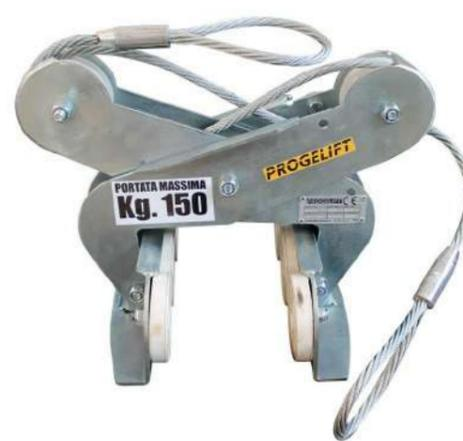
Le pinze raddrizzanti per pannelli e piastre sono dotate di pastiglie in gomma sostituibili; di seguito sono evidenziate le tipologie di pastiglie disponibili, caratterizzate da differenti durezze. La pinza è inoltre dotata di un pomolo di fissaggio per il mantenimento della stessa in apertura. **Le pinze vengono fornite con la relativa fune d'acciaio.**
